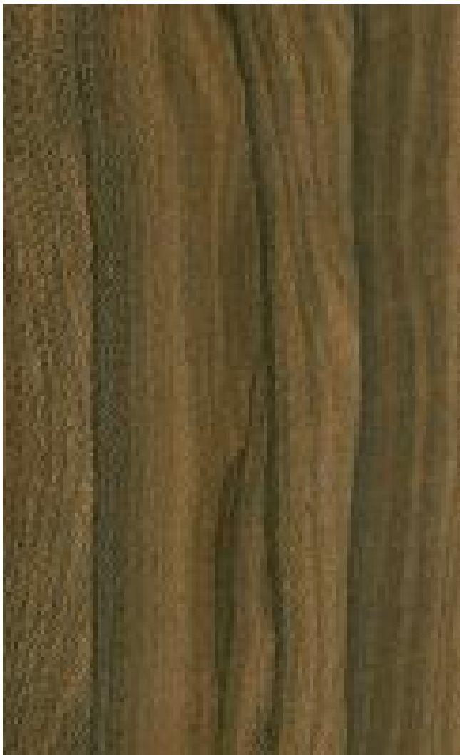
Ziricote ( Cordia dodecandra ) – Querschnitt ca. 10x
