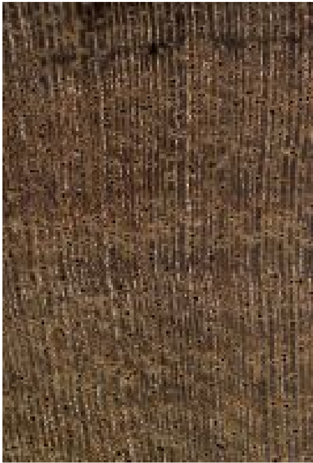
Ziricote ( Cordia dodecandra ) – Querschnitt ca. 10x
