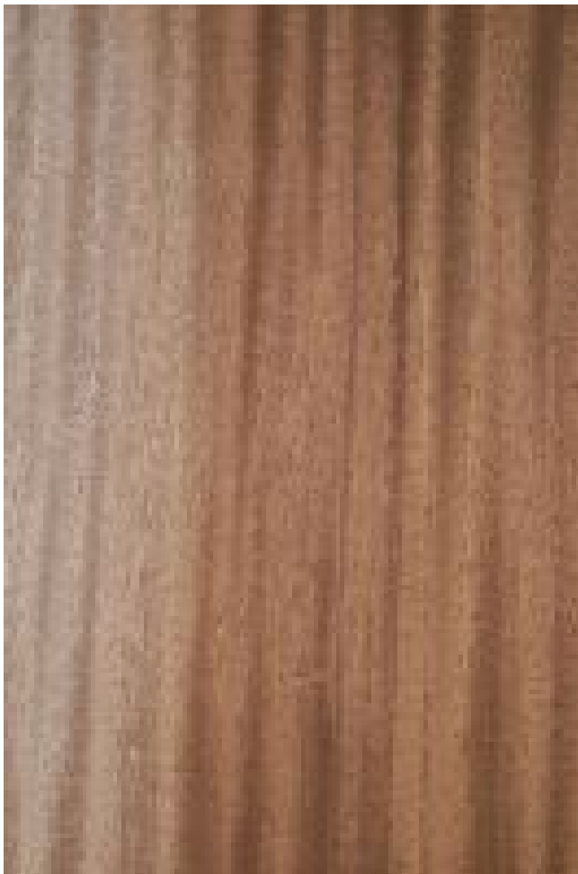
Tiama ( Entandrophragma angolense ): Radiale Oberfläche (nat. Größe)
