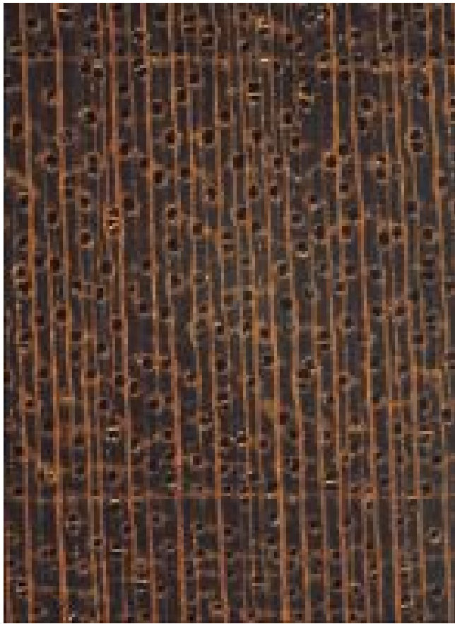
Tiama ( Entandrophragma angolense ): Querschnitt (ca. 12x)
