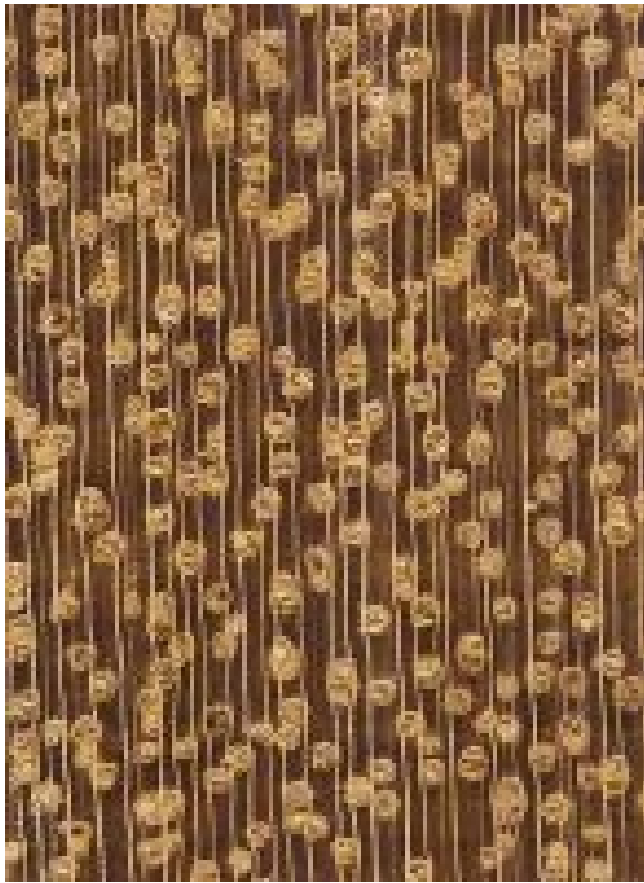
Tatajuba ( Bagassa guianensis ) – Querschnitt (ca. 12x)
