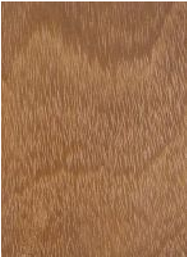
Tatajuba ( Bagassa guianensis ) – Tangentiale Oberfläche (natürliche Größe)
