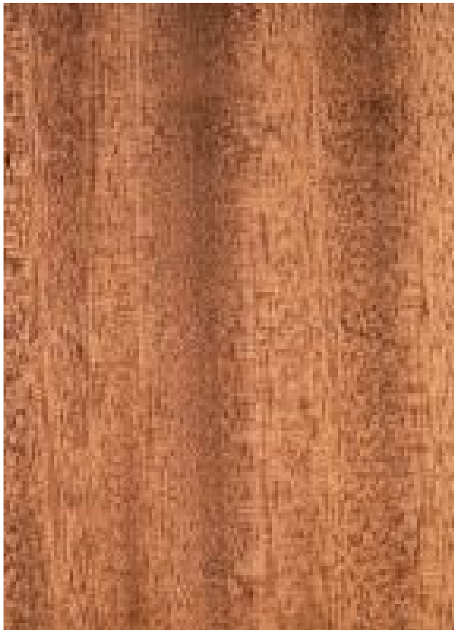
Sipo ( Entandrophragma utile ) – Radiale Oberfläche (natürliche Größe)
