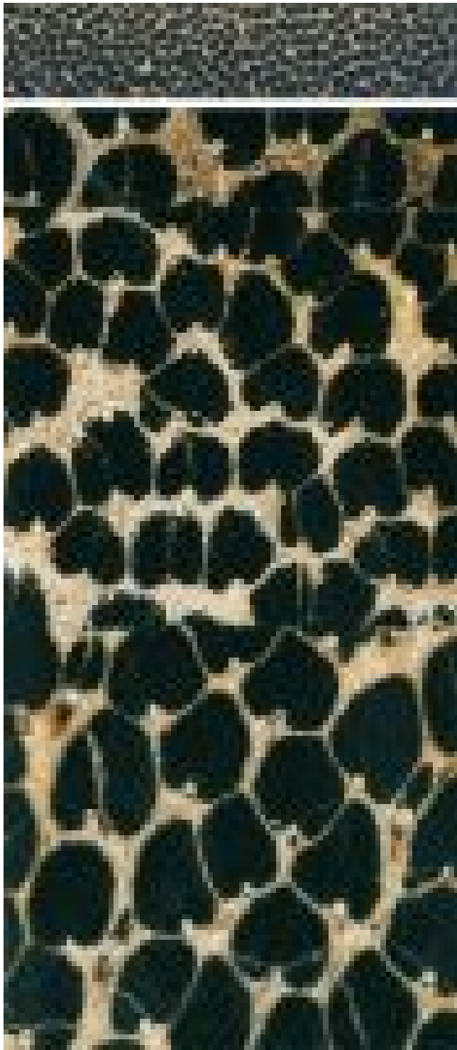
Black palm ( Iriarteia deltoidea ) – Querschnitt einer Lamelle in natürlicher Größe (oben); etwa 10-fach vergrößert, blockverleimt (unten)
