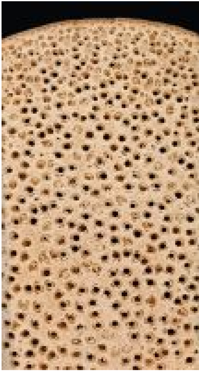
Rattan ( Calamus spp.) – Querschnitt (ca. 12-fach)
