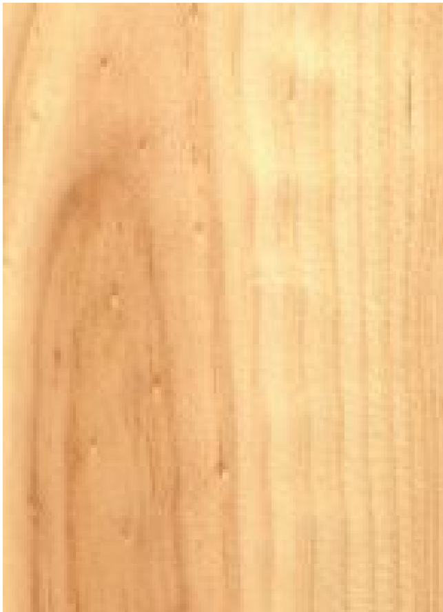
Radiata pine ( Pinus radiata ) – Tangentiale Oberfläche (natürliche Größe)
