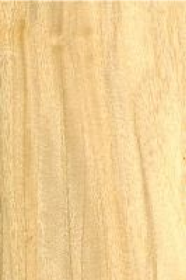
Primavera (Roseodendron donnell-smithii): Querschnitt (ca. 12x)
