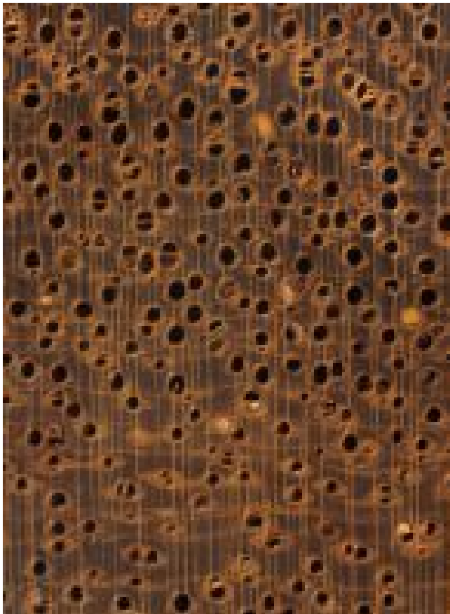
Merbau ( Intsia sp.): Querschnitt (ca. 12x)
