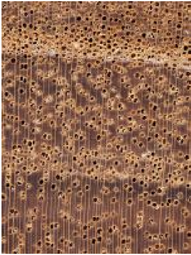
Weißes Meranti ( Shorea sp.): Querschnitt (ca. 12x)
