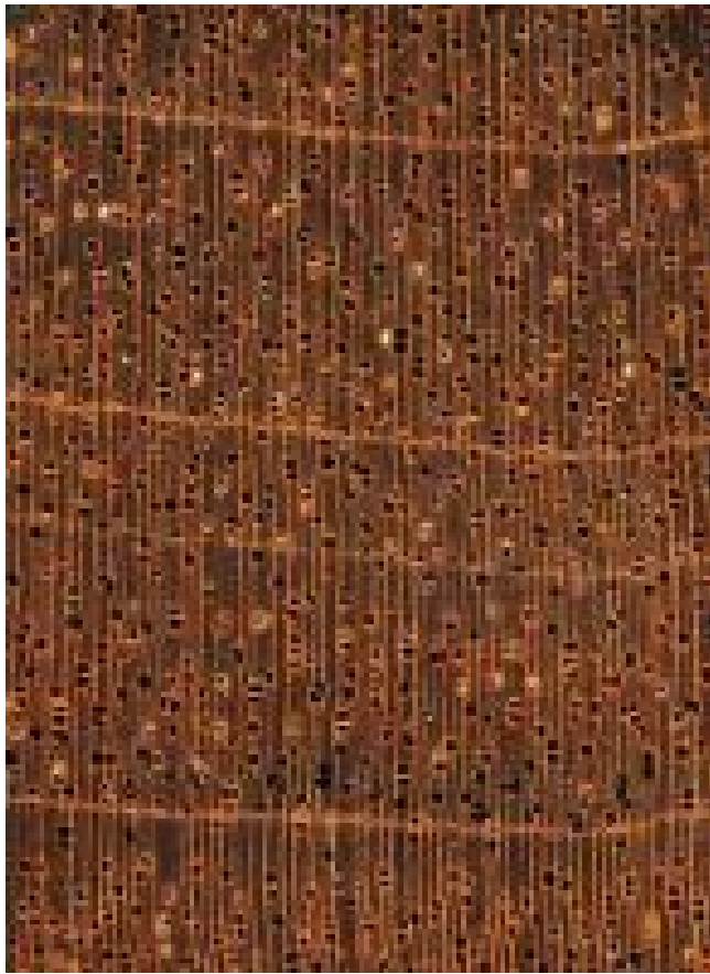
Mahagoni ( Swietenia sp.) – Querschnitt (ca. 12-fach)
