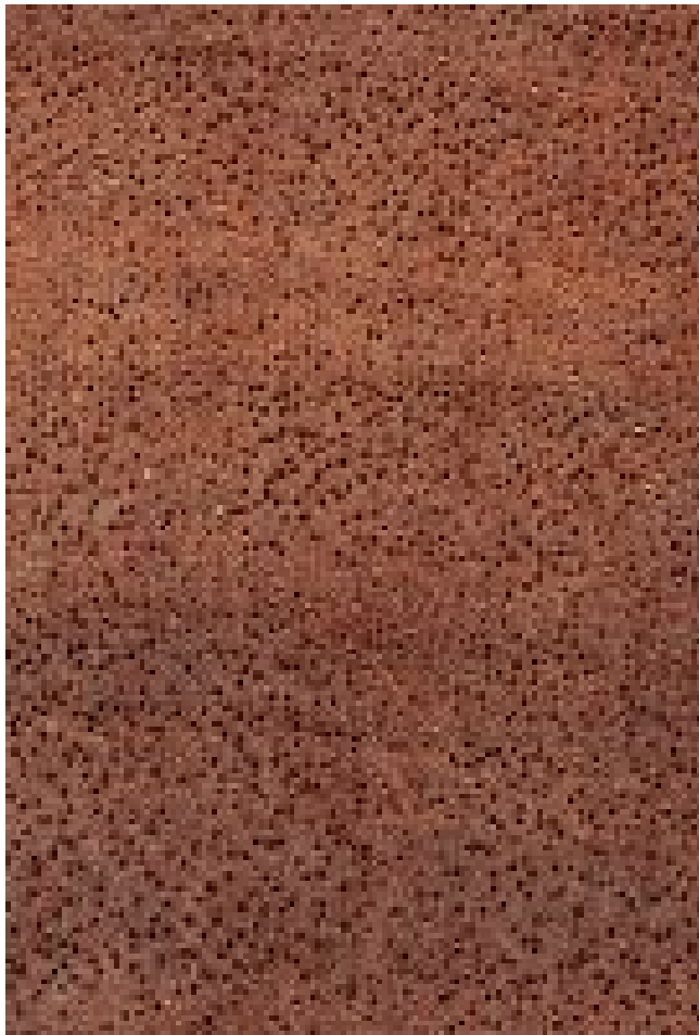
Kotibé ( Nesogordonia papaverifera ) – Querschnitt (ca. 10-x)
