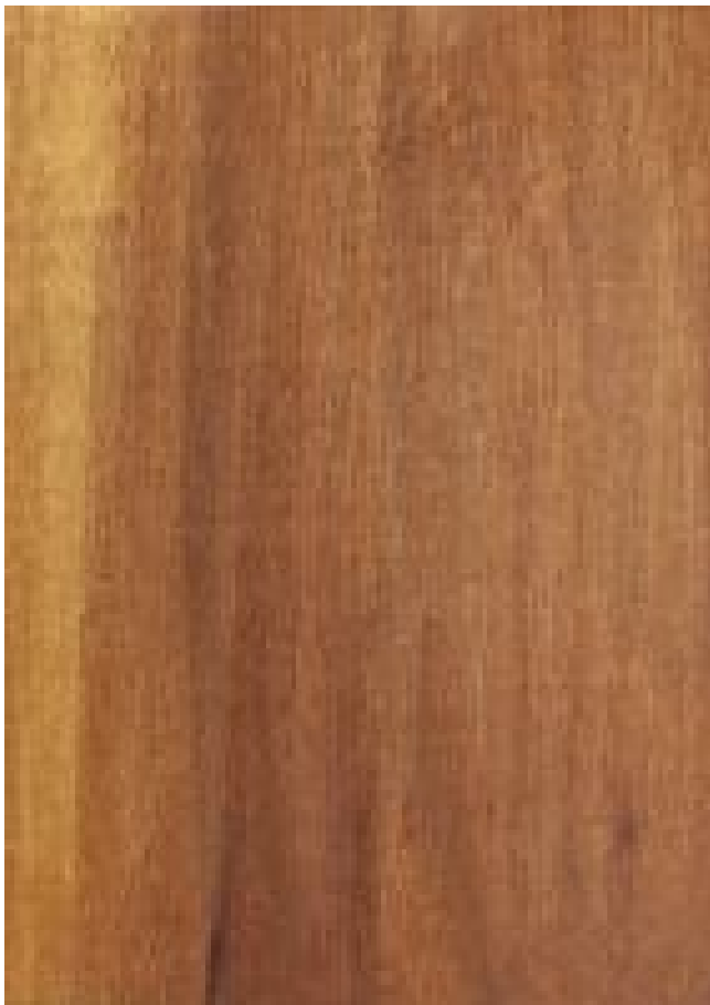
Kotibé ( Nesogordonia papaverifera ) – Tangentiale Oberfläche (natürliche Größe)
