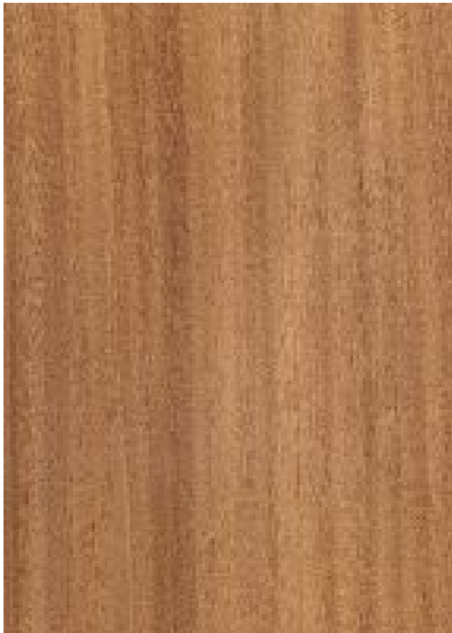
Kotibé ( Nesogordonia papaverifera ) – Radiale Oberfläche (natürliche Größe)
