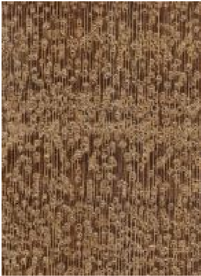
Itaúba (Mezilaurus spp.) – Querschnitt (ca. 10-fach)
