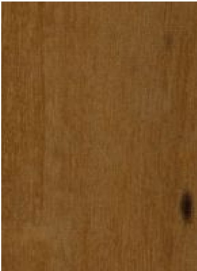
Itaúba (Mezilaurus spp) – Tangentiale Oberfläche (natürliche Größe)
