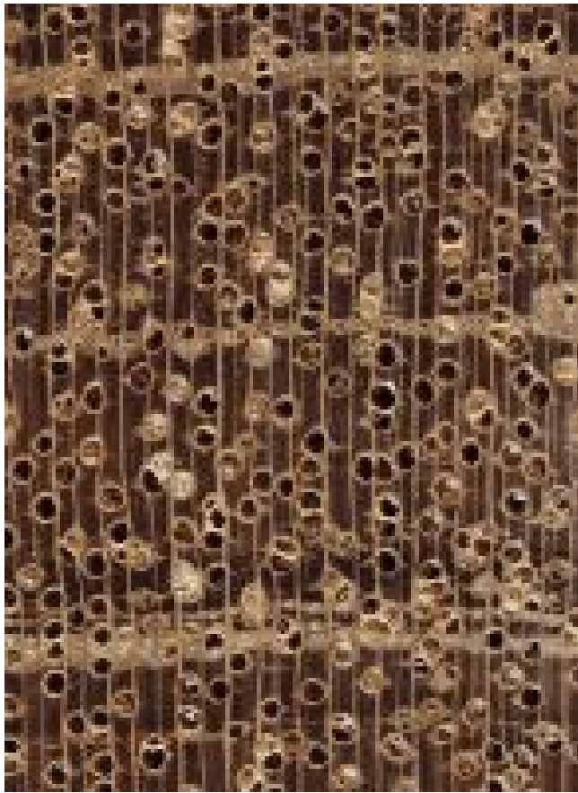
Gerutu ( Parashorea spp.): Querschnitt (ca. 12x)
