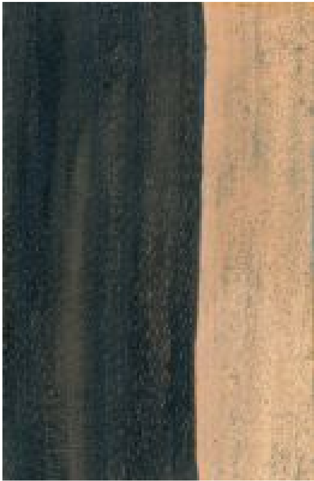
Schwarzes Ebenholz ( Diospyros crassiflora ): radiale Oberfläche (natürliche Größe)
