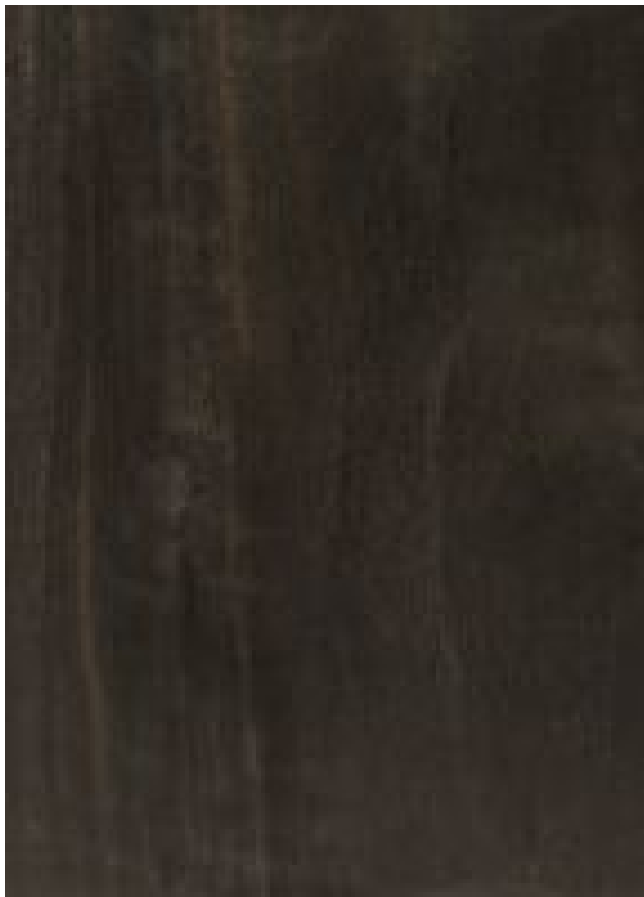
Schwarzes Ebenholz ( Diospyros crassiflora ): tangentiale Oberfläche (natürliche Größe)
