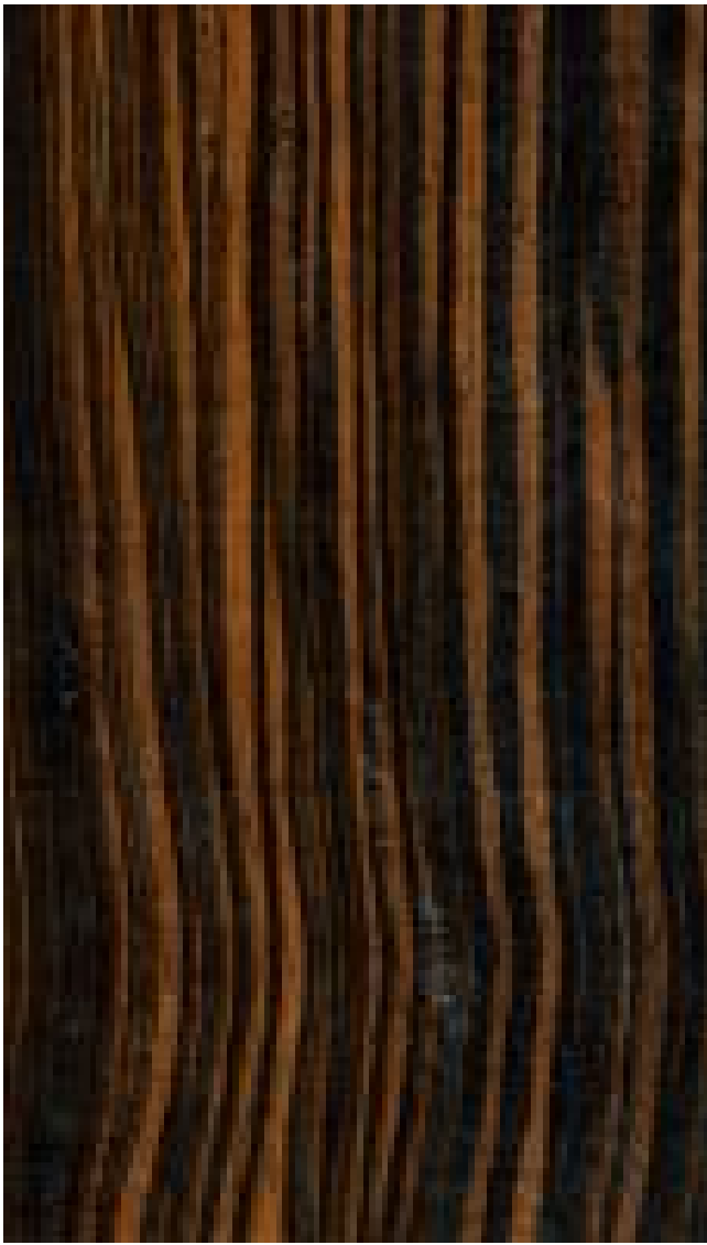
Farbstreifiges Ebenholz ( Diospyros celebica ): radiale Oberfläche (natürliche Größe)
