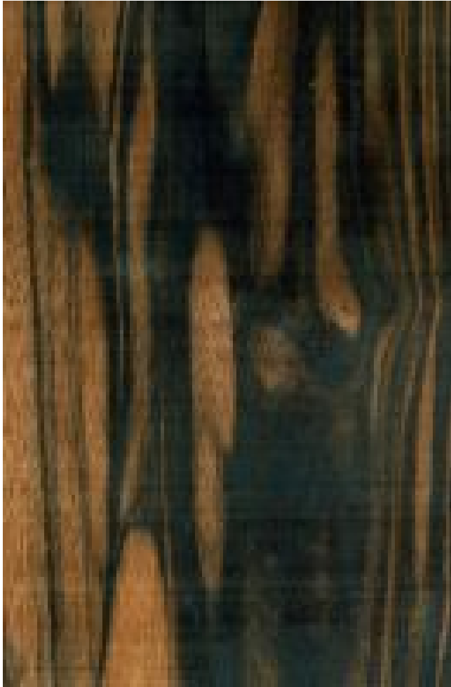
Farbstreifiges Ebenholz ( Diospyros celebica ): tangentiale Oberfläche (natürliche Größe)
