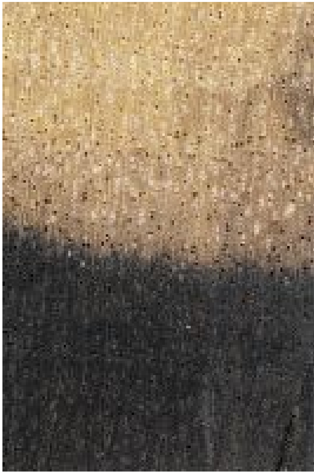
Schwarzes Ebenholz ( Diospyros crassiflora ): Querschnitt (ca. 12x)
