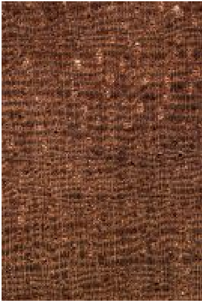
Cambará ( Erisma uncinnatum ) – Querschnitt ca. 10x
