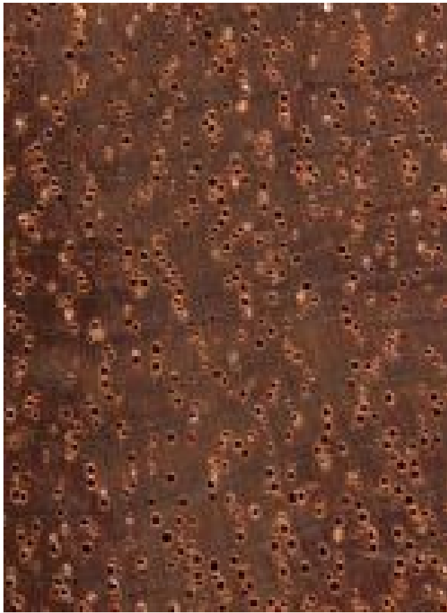
Bintangor ( Calophyllum spp.): Querschnitt (ca. 12x)
