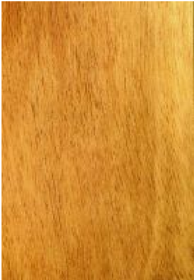
Bilinga ( Nauclea diderrichii ) – tangential Oberfläche (natürliche Größe)
