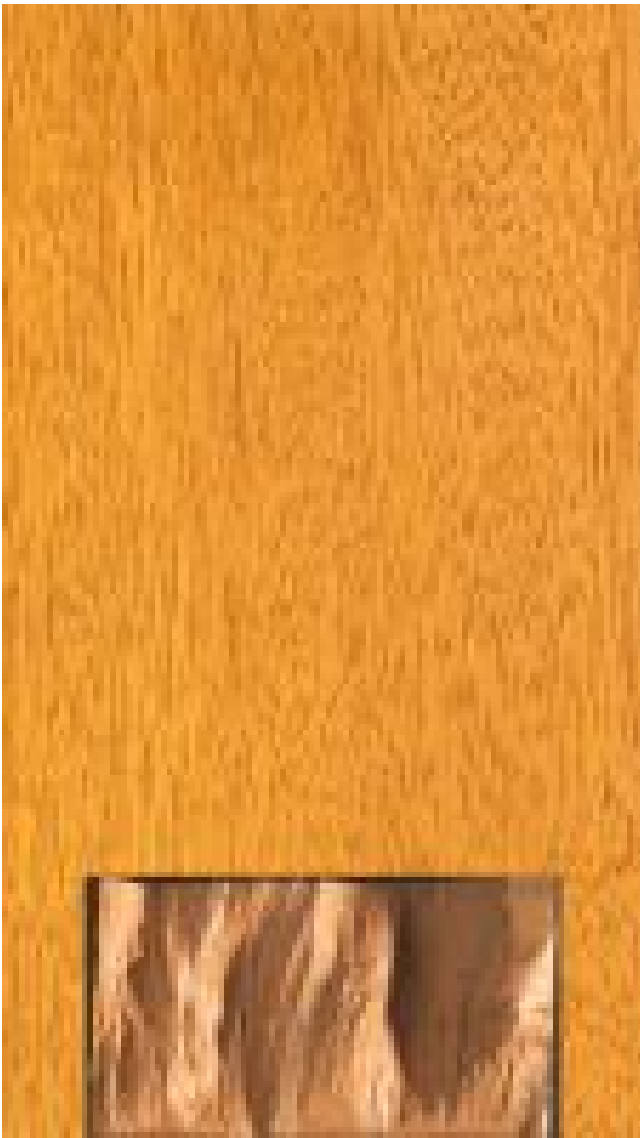
Bilinga (Nauclea diderrichii) – radiale Oberfläche (natürliche Größe) mit Wechseldrehwuchs (Bildausschnitt unten)
