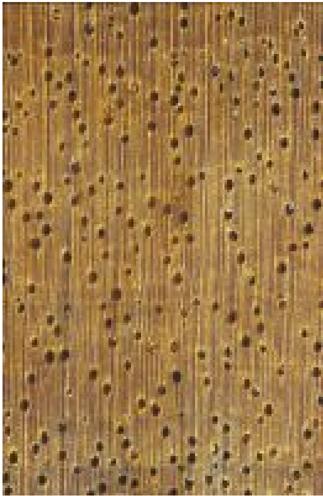
Bilinga ( Nauclea diderrichii ) – Querschnitt (ca. 12x)
