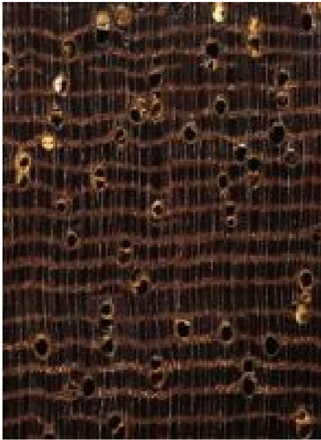
Azobé ( Lophira alata ) – Querschnitt (ca. 12x)
