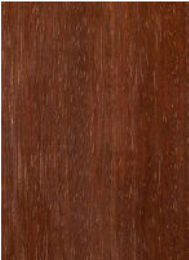
Azobé ( Lophira alata ) – Tangentiale Oberfläche (natürliche Größe)
