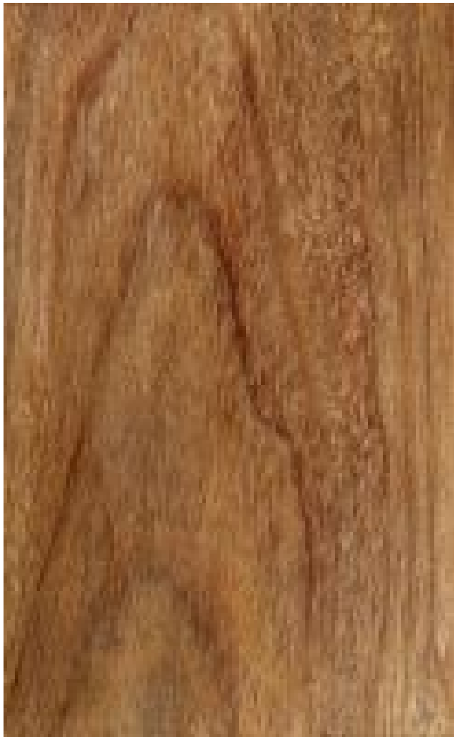
Angelim vermelho ( Dinizia excelsa ) – tangential Oberfläche (natürliche Größe)
