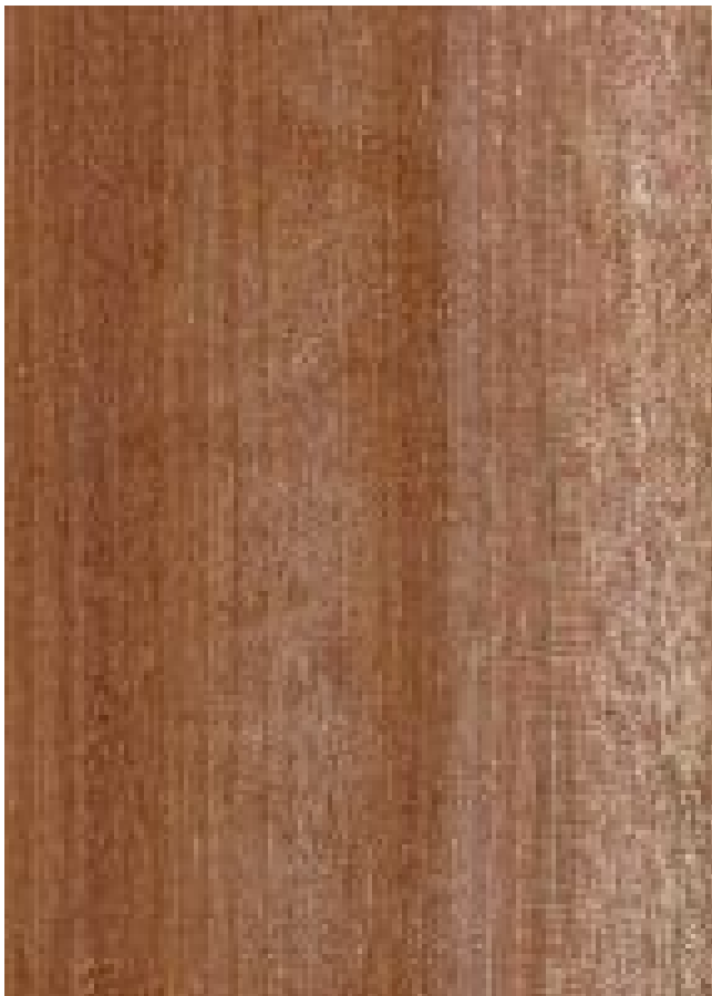
Angelim vermelho ( Dinizia excelsa ) – radiale Oberfläche (natürliche Größe)
