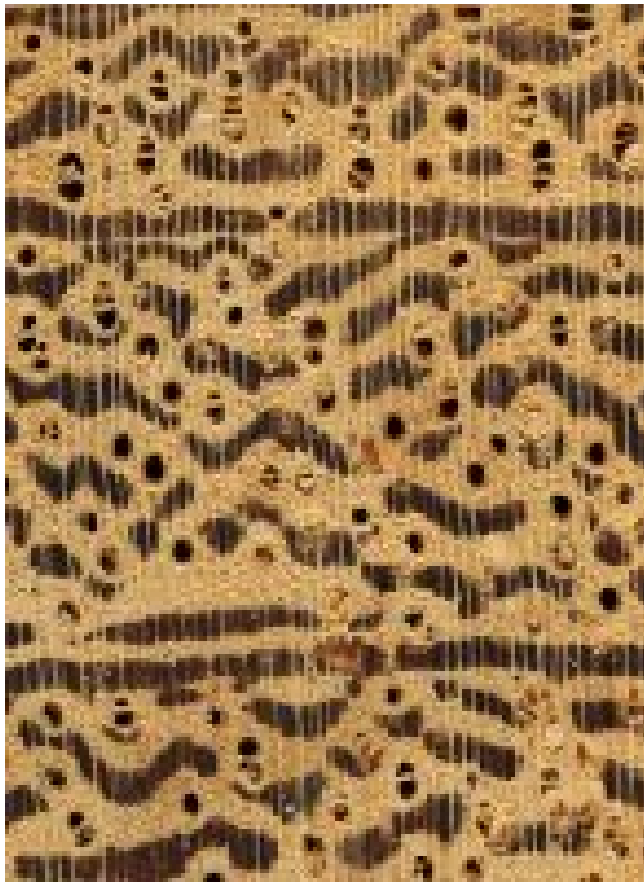
Andira (Andira spp.): Querschnitt (ca. 12x)
