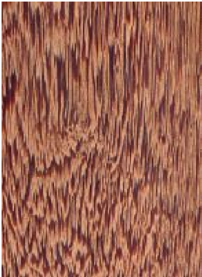
Andira (Andira spp.): Tangentiale Oberfläche (natürliche Größe)
