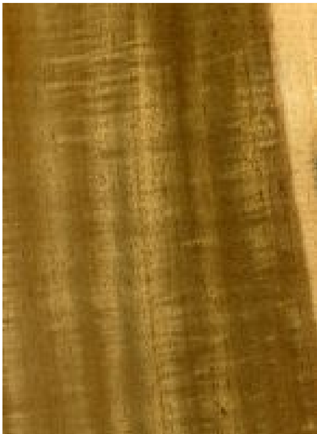
Mangium ( Acacia mangium ): Radiale Oberfläche (natürliche Größe)
