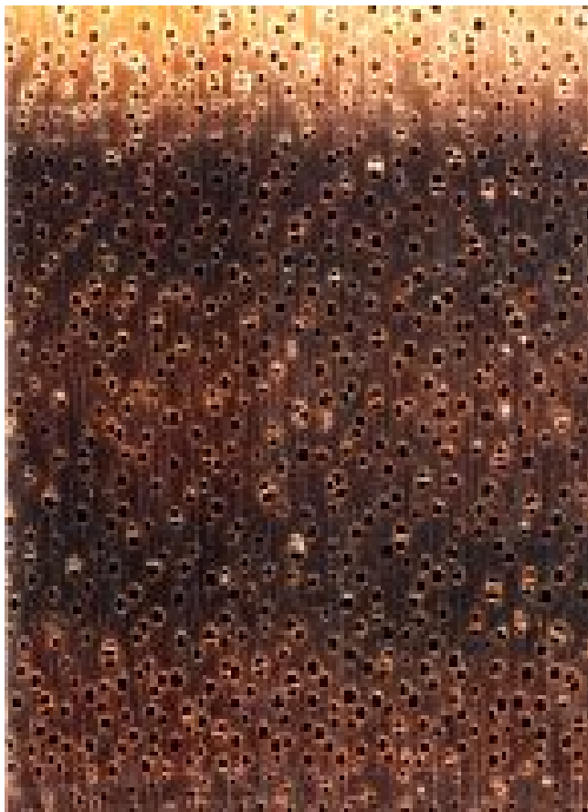
Mangium ( Acacia mangium ): Querschnitt (ca. 12x)
