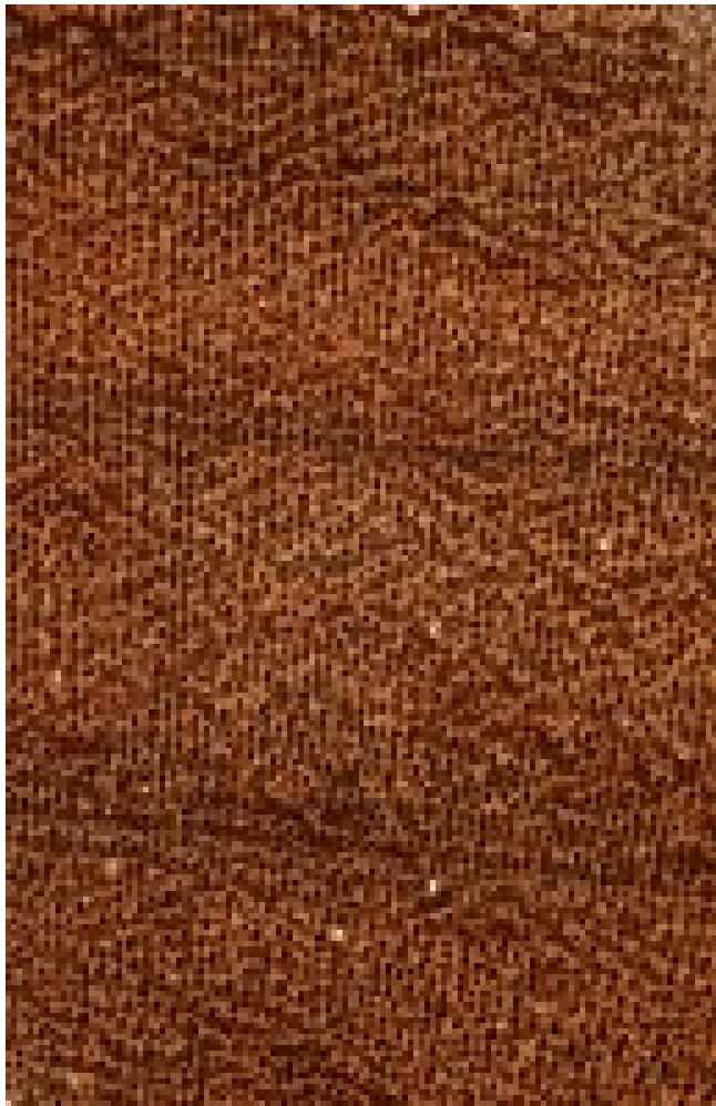
Afrosmosia ( Pericopsis elata ) – Querschnitt 10-fach vergrößert
