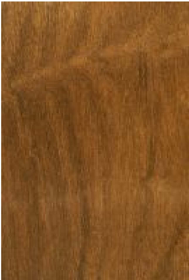
Afrosmosia ( Pericopsis elata ) – Querschnitt 10-fach vergrößert
