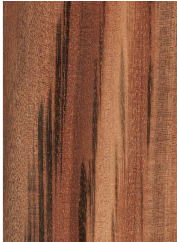
Gonçalo alves ( Astronium sp.): Querschnitt (ca. 12x) und radiale Oberfläche (natürliche Größe)
