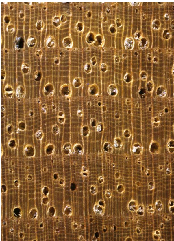
Hickory ( Carya alba ): Querschnitt (ca. 12x) und tangentiale Oberfläche (natürliche Größe)
