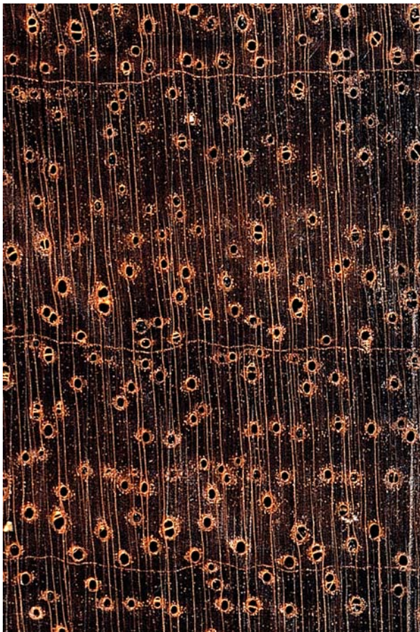
Tzalam ( Lysiloma latisiliquum ): Querschnitt (ca. 12x) und radiale Oberfläche (natürliche Größe)
