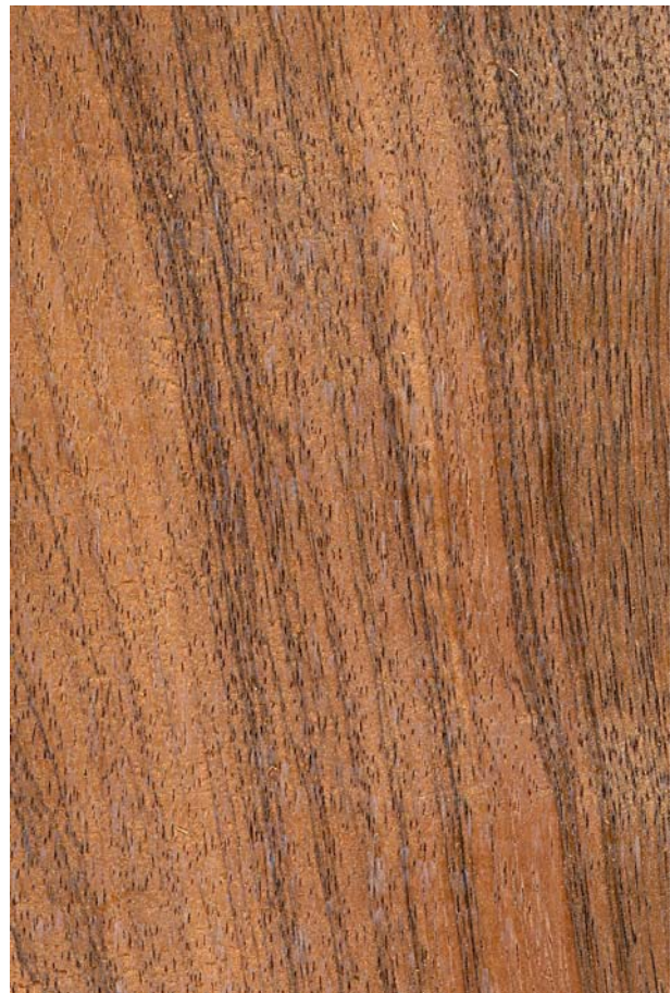
Tzalam ( Lysiloma latisiliquum ): Querschnitt (ca. 12x) und radiale Oberfläche (natürliche Größe)
