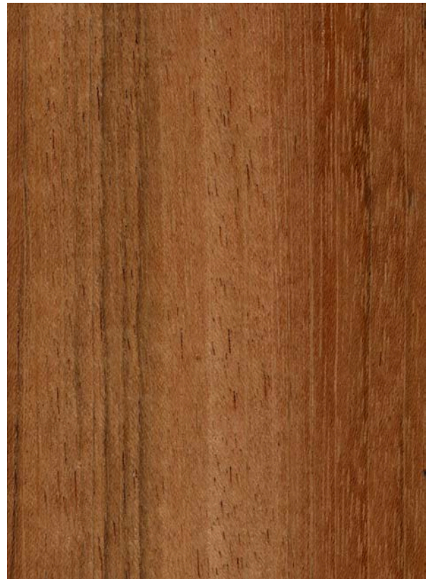
Jatobá ( Hymenaea spp.): Querschnitt (ca. 10x) und tangentiale Oberfläche (natürliche Größe)
