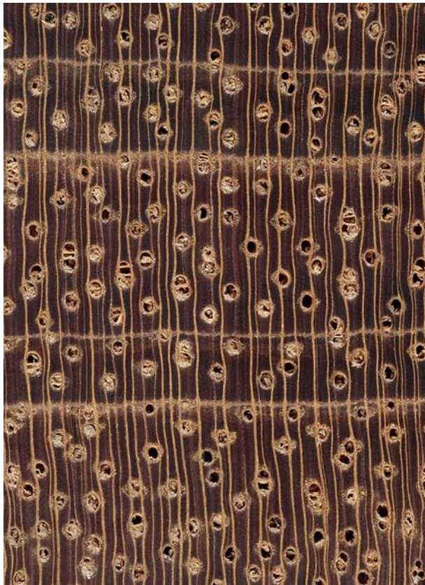
Jatobá ( Hymenaea spp.): Querschnitt (ca. 10x) und tangentiale Oberfläche (natürliche Größe)
