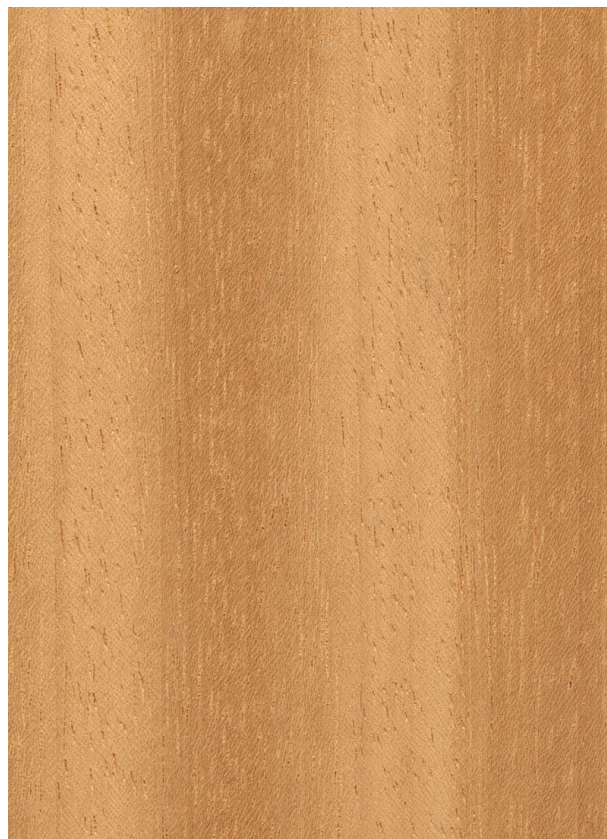
Abachi ( Triplochiton scleroxylon ) Querschnitt (ca. 12x) und radiale Oberfläche (natürliche Größe)
