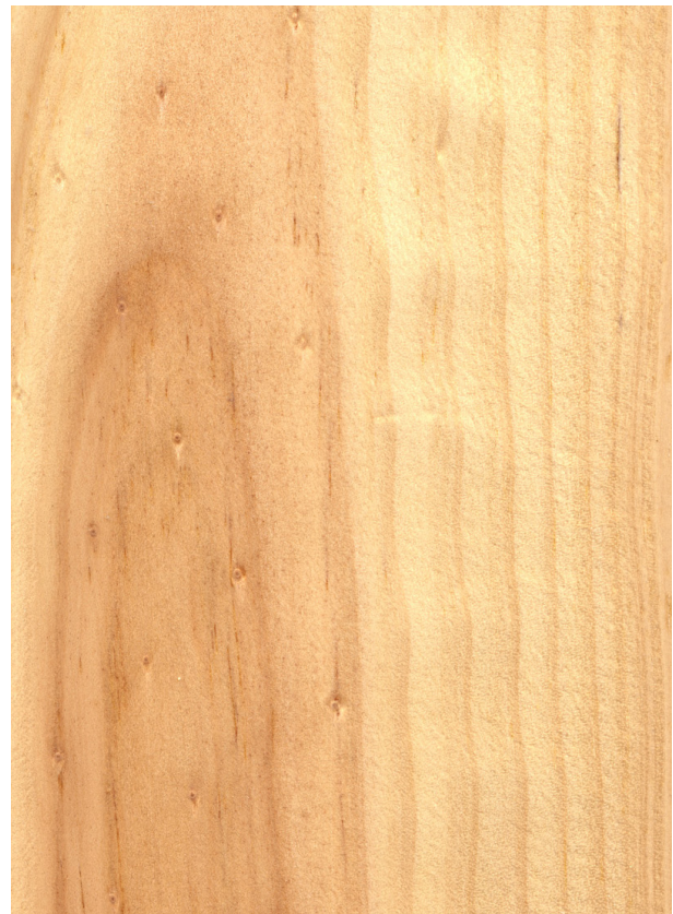
Radiata pine ( Pinus radiata ): Querschnitt (ca. 12x) und tangentiale Oberfläche (natürliche Größe)
