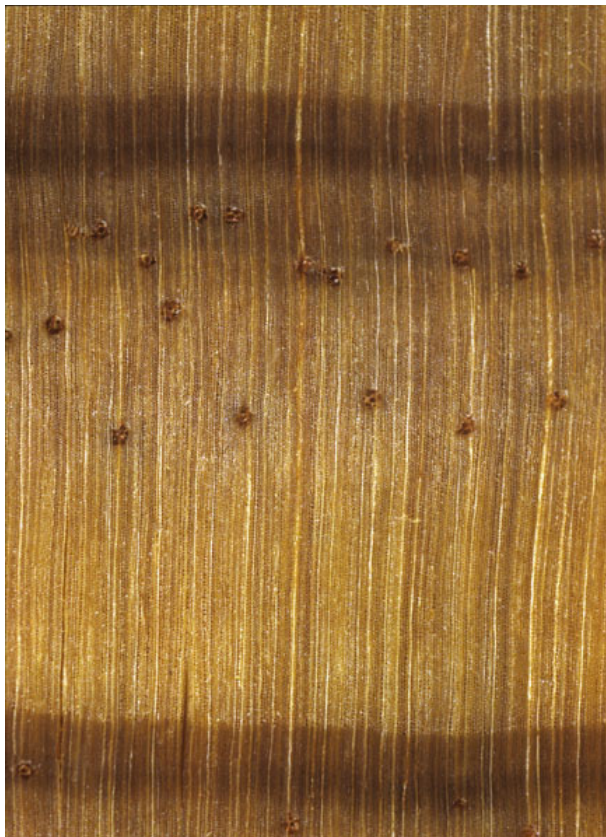
Radiata pine ( Pinus radiata ): Querschnitt (ca. 12x) und tangentiale Oberfläche (natürliche Größe)
