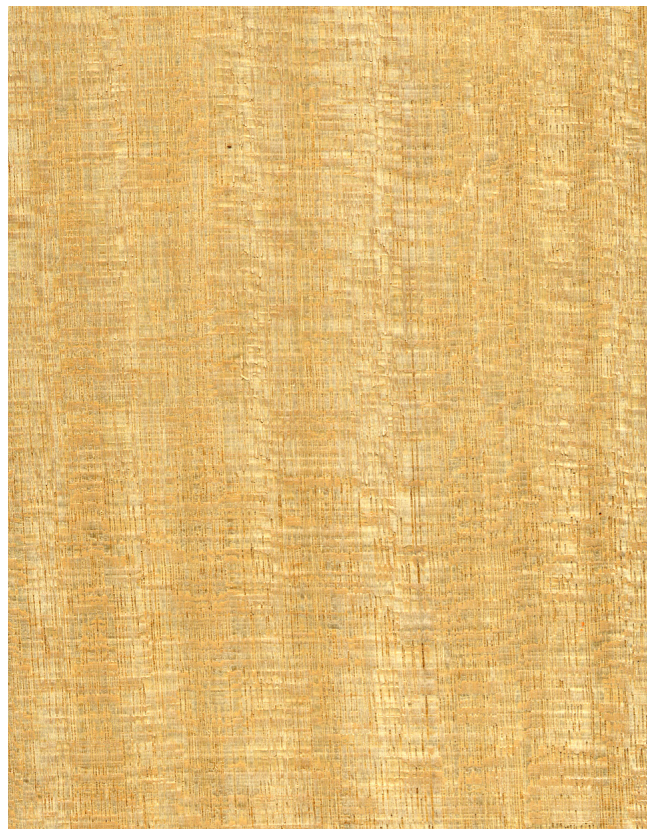
Gelbes Meranti ( Shorea sp.): Querschnitt (ca. 12x) und radiale Oberfläche (natürliche Größe)
