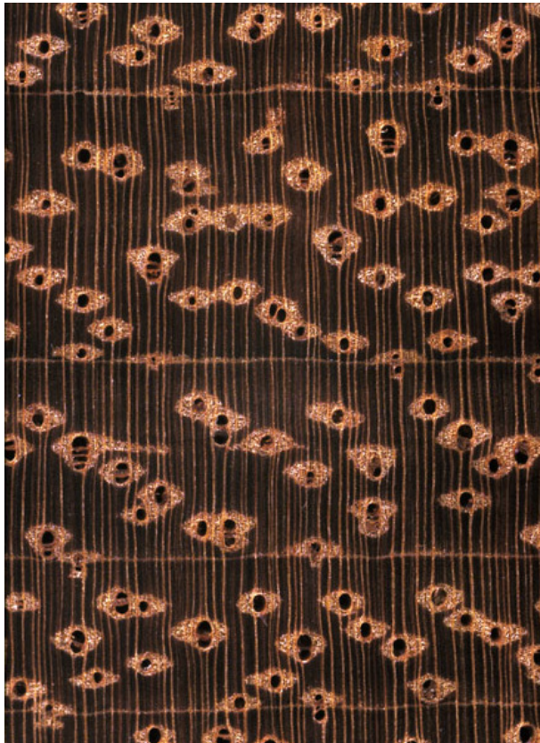
Afzelia ( Afzelia spp.): Querschnitt (ca. 12x) und tangentiale Oberfläche (natürliche Größe)
