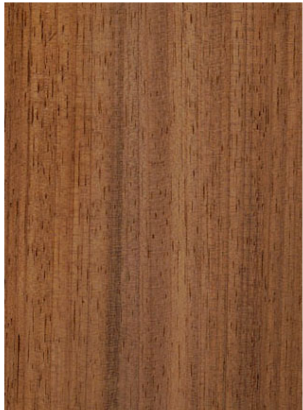
Iroko ( Milicia excelsa .): Querschnitt (ca. 12-x) und tangentiale Oberfläche (natürliche
