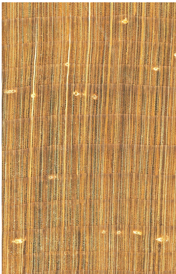
Sitka-Fichte ( Picea sitchensis ), feijnähriges Material aus Naturbestand: Querschnitt (ca. 12x), und radiale Oberfläche (natürliche Größe)
