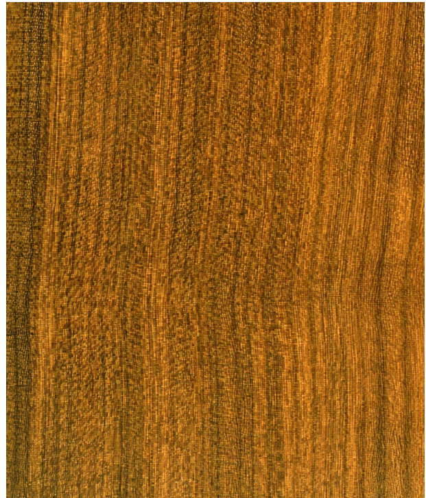
Afrormosia ( Pericopsis elata ): Querschnitt ca. 10x und radiale Oberfläche (natürliche Größe)
