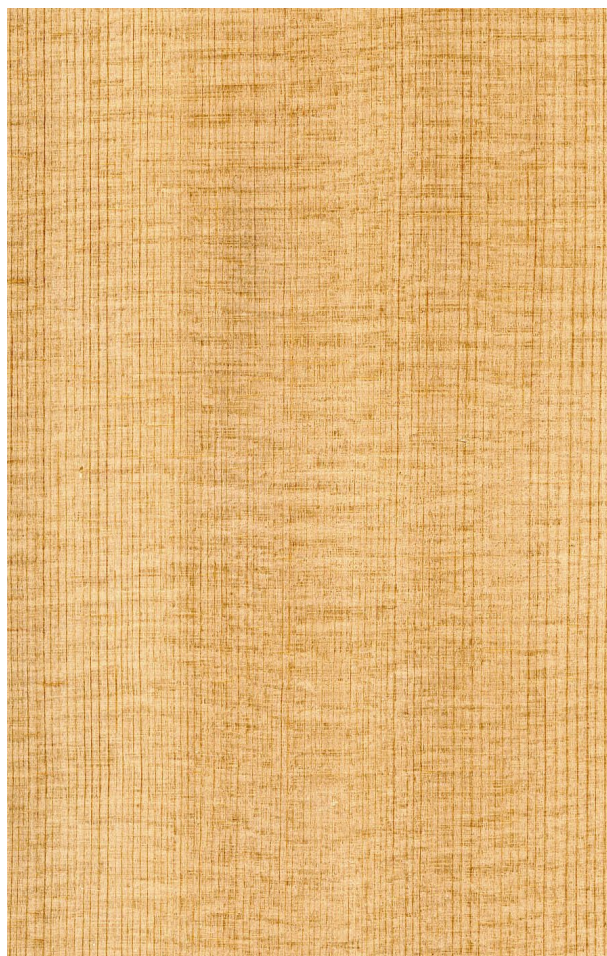
Sitka-Fichte ( Picea sitchensis ), feijnähriges Material aus Naturbestand: Querschnitt (ca. 12x), und radiale Oberfläche (natürliche Größe)
