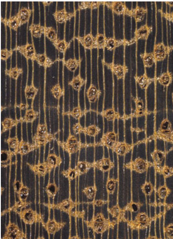
Iroko ( Milicia excelsa .): Querschnitt (ca. 12-x) und tangentiale Oberfläche (natürliche
