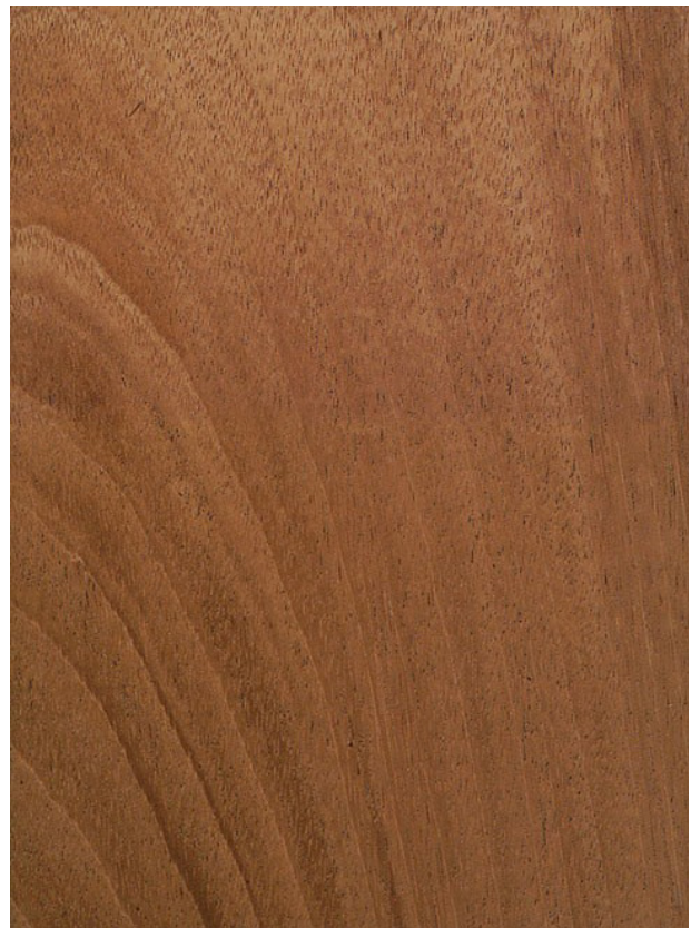
Mahagoni ( Swietenia sp.): Querschnitt (ca.12x) und tangentiale Oberfläche (natürliche Größe)
