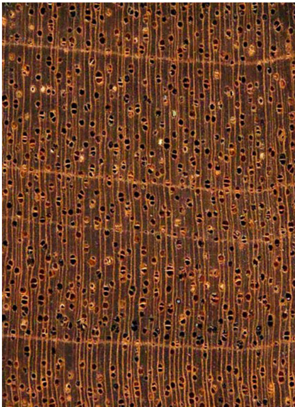
Mahagoni ( Swietenia sp.): Querschnitt (ca.12x) und tangentiale Oberfläche (natürliche Größe)
